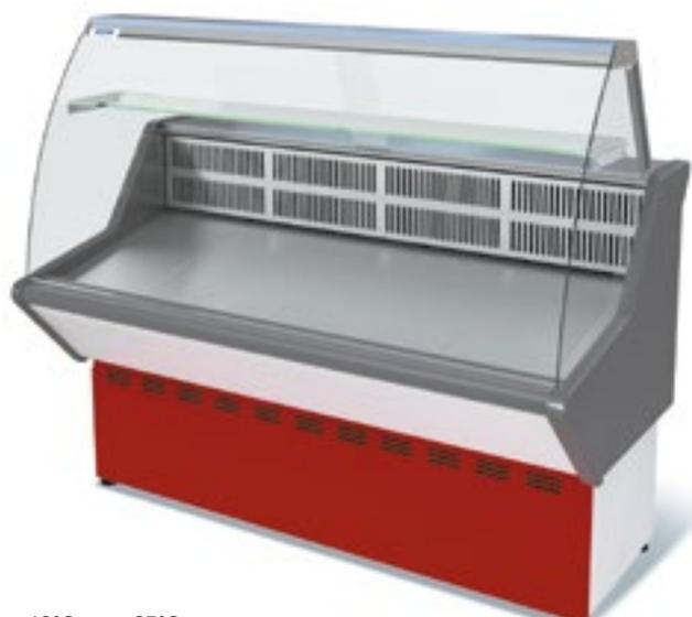
**Технические характеристики:** • температура окружающей среды +12°C ... +25°C; • номинальное напряжение (~ 50 Гц) 220В; • холодообеспечение: встроенное; • тип охлаждения: статическое; • тип оттаивания: автоматическое; • способ оттаивания: естественными теплопритоками для среднетемпературных витрин, ТЭН для низкотемпературных и универсальных витрин; • хладагент: R134a / R404A.
